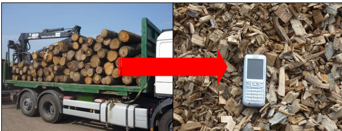
Ábra 28: „Magas“ (P45-63, A1,5-3, M30-40) minőségű faapríték szénerőművi felhasználásra
