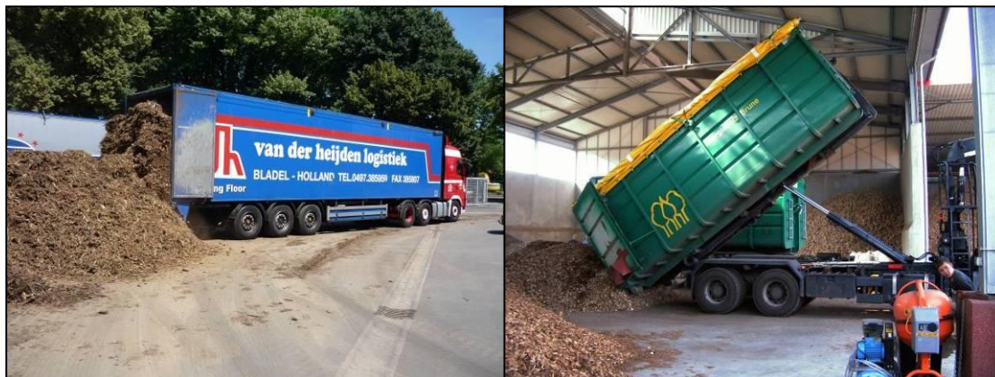
Ábra 32: Önürítő „walking floor” kamion (90 m 3 - bal oldal) és „roll konténeres” tehergépjármű (2 x 35 m 3 = 70 m 3 - jobb oldal)
